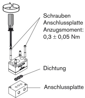
→ Dichtung in das Ventil einlegen.
