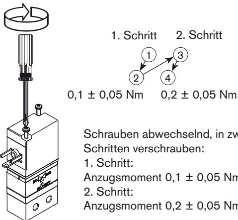
→ Spule auf Gehäuse befestigen.
